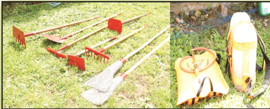
Gambar 3. Peralatan tangan sederhana untuk pemadaman kebakaran hutan dan lahan
